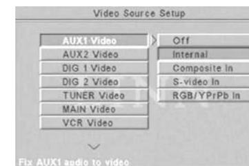
**COMPOSITE IN** - Version européenne : lorsque la source AUX 1 ou AUX 2 est sélectionnée, toute source vidéo raccordée à la prise péritel VCR SCART de magnétoscope de votre CLASSIK Movie Di est acheminée jusqu'à la prise péritel TV SCART de télévision de l'appareil. Version américaine : lorsque la source AUX 1 ou AUX 2 est sélectionnée, toute source vidéo raccordée à l'entrée CVBS IN de votre CLASSIK Movie Di est acheminée jusqu'à la sortie CVBS OUT de l'appareil.
