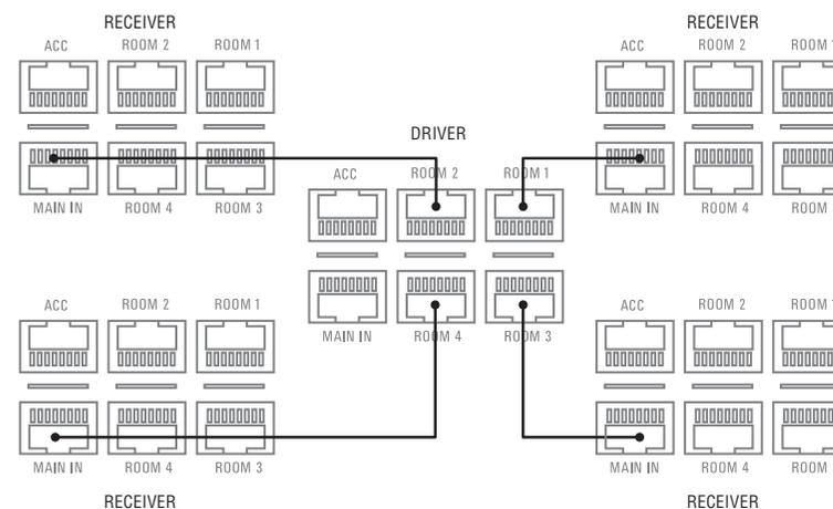
Le groupe de pilotage transmet un signal stéréo audio standard aux récepteurs. Par conséquent, il faut brancher une paire de haut-parleurs de type approprié sur chaque récepteur de ce réseau.
