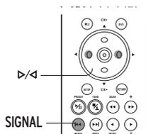
Cette fonction de niveau silencieux vous permet de couper le signal provenant du Tuner si la puissance de ce signal tombe au-dessous d'un niveau prédéterminé.
