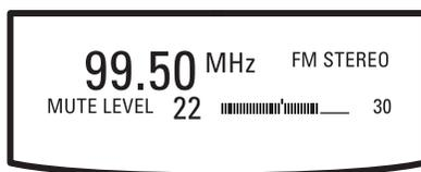
MUTE LEVEL (Niveau de silencieux) et sa valeur apparaissent sur le panneau avant et sont suivis de la barre d'affichage du niveau du silencieux.
