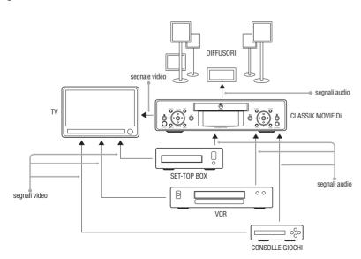
Se si preferisce o se il TV non dispone di un numero di connettori sufficiente, è possibile collegare le uscite audio e video al CLASSIK Movie Di. Chi dispone della versione SCART del CLASSIK Movie Di può fare ciò collegando in cascata i componenti ausiliari, con un collegamento all'unità – vedere schema sequente.
