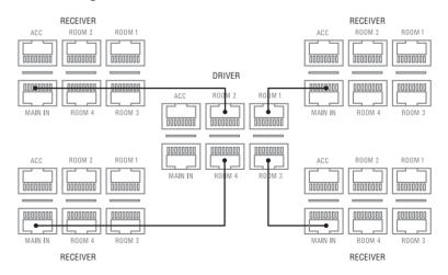
L'unità principale invia un segnale audio stereo standard, per cui ad ogni unità ricevente del sistema devono essere collegati due altoparlanti di tipo idoneo.
