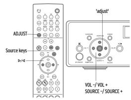
Se si utilizza un altoparlante centrale come parte del sistema hi-fi/AV, durante la riproduzione di un DVD o l'ascolto di un CD (vedere Modalità audio surround nel capitolo Riproduzione dischi) può succedere di voler regolare il volume dell'altoparlante centrale senza modificare quello degli altri altoparlanti. Per fare ciò è sufficiente regolare il trim dell'altoparlante centrale.
