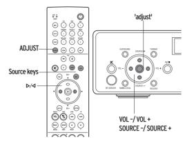
Se si utilizza un altoparlante subwoofer come parte del sistema AV, può succedere, durante la riproduzione di un DVD, di voler regolare il volume del subwoofer senza modificare quello degli altri altoparlanti. Per fare ciò è sufficiente regolare il trim del subwoofer.
