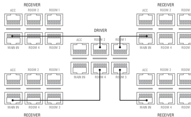
Der Treiber überträgt ein stereophones Standardaudiosignal an die Receiver. Aus diesem Grund muss an jeden Receiver des CONNECT-Systems ein geeignetes Lautsprecherpaar angeschlossen sein.
