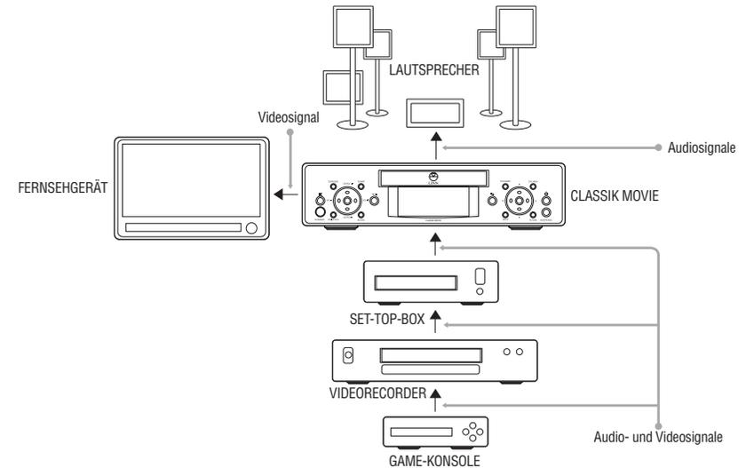
Wenn Sie die amerikanische Geräteausführung besitzen, können Sie die Audio- und Videoausgänge der Zusatzsignalquellen einzeln an das CLASSIK Movie anschließen. Vergleichen Sie hierzu das Diagramm weiter unten.
