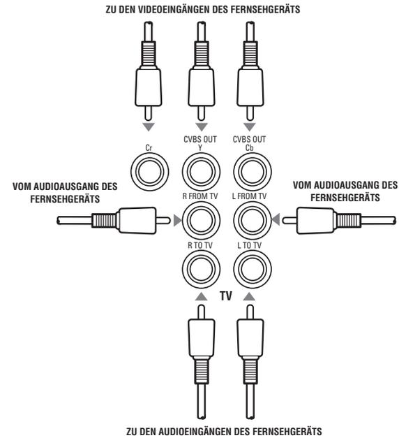
Wenn das Fernsehgerät über einen S-Video-Eingang verfügt, nehmen Sie den Anschluss entsprechend der Abbildung vor.
