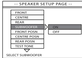
Mithilfe der nächsten Menüs können Sie die Lautsprecherpositionen in das CLASSIK Movie eingeben, so dass das Gerät bei bestimmten Lautsprechern Zeitverzögerungen hinzufügen kann. Auf diese Weise wird sichergestellt, dass der Schall aller Lautsprecher Ihre Hörposition zum selben Zeitpunkt erreicht.
