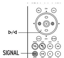
Mithilfe der Signalunterdrückungsfunktion können Sie den Tunerausgang stummschalten, wenn die Signalstärke unterhalb eines festgelegten Pegels liegt.
