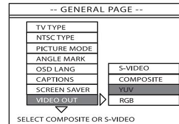
Wenn das Fernsehgerät RGB-Signale akzeptiert und Sie das CLASSIK Movie entsprechend an das Fernsehgerät angeschlossen haben, aktivieren Sie den RGB-Eingang.
