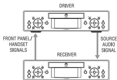
Sie können auch alle Receiver über den Treiber steuern. Dies ist bei einer Party nützlich, da dieselbe CD oder Radiosendung in maximal fünf verschiedenen Zimmern wiedergegeben werden kann.
