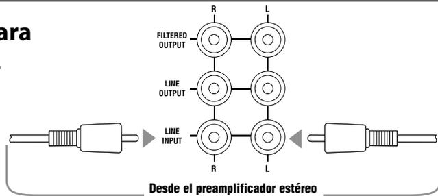
**Conexión a un preamplificador estéreo y un amplificador de potencia** si se utiliza con altavoces pequeños (respuesta en baja frecuencia limitada)
