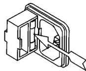
Für den Einbau der Sicherung wählen Sie zunächst die für Ihre Ortsspannung korrekte Sicherung - 400 mA Spannungsschubsicherung für 220 V und 240 V, und 800 mA Spannungsschubsicherung für 100 V und 120 V. Öffnen Sie die Sicherungslade an der linken Seite der Netzanschlussschleuse, legen Sie die Sicherung in die hintere Kammer und schließen Sie die Lade wieder.
