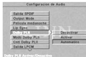
El Dolby Pro-Logic II es una forma de procesado de audio que genera cinco canales de salida a partir de cualquier fuente auxiliar o interna de dos canales, como por ejemplo un CD de audio, una señal de radio estéreo o una señal de audio de TV. Esto se consigue utilizando un avanzado descodificador de sonido envolvente que extrae las cualidades espaciales de la señal original sin añadir ningún sonido nuevo.
