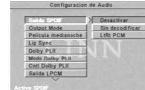
Si *está utilizando* un receptor de A/V externo, seleccione **Sin decodificar** (los datos entregados en la salida DIGITAL OUT son idénticos a los de la fuente).
