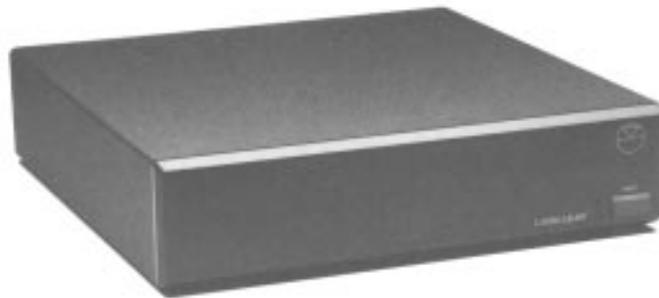
INSTALLATION Packen Sie den LK 100 sorgfältig aus und bewahren Sie die Verpackung für spätere Transportzwecke auf. Achten Sie bitte darauf, daß der Endverstärker geerdet ist und daß für ausreichende Belüftung gewährleistet ist. Damit der Endverstärker keine Brummeinstreuung verursacht, sollte er in einer Entfernung von mindestens 15 cm vom Plattenspieler aufgestellt werden.
