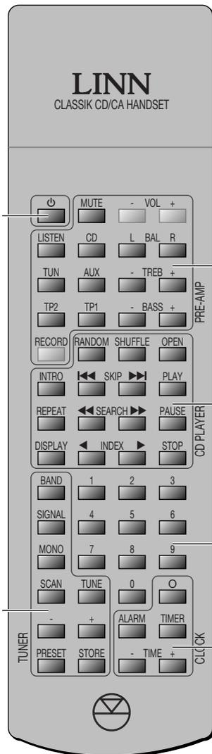
Der IKEMI und der GENKI werden mit einer Fernbedienung geliefert, die Zugang zu allen Funktionen gibt, die auch auf dem Vorderpaneel zur Verfügung stehen. Außerdem bietet sie weitere Funktionen, u. a. Auswahl von Titeln nach Titelnummern und die Programmierung einer Auswahl von Titeln.
